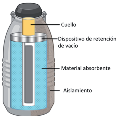
Figura 1. Representación esquemática de un tanque dry shipper o de nitrógeno líquido en seco.
